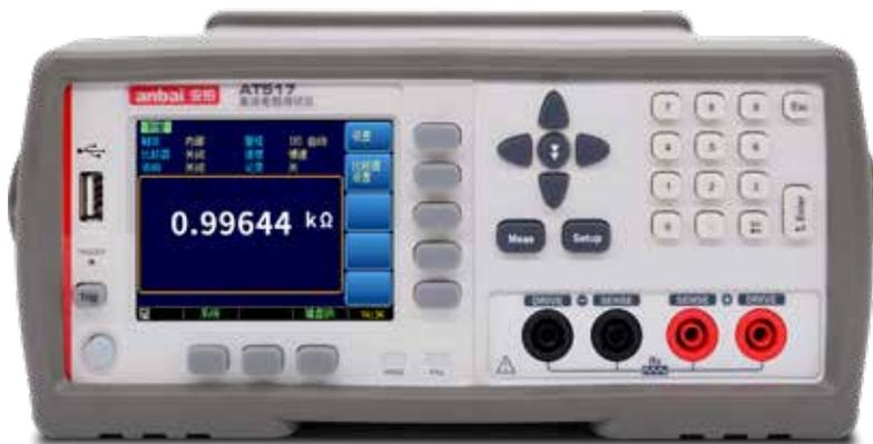
■ 电源要求 电压 220VAC 频率 50Hz/60Hz 功率最大 20VA
