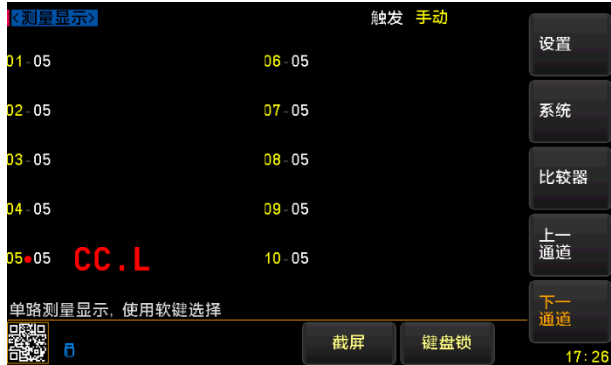
图 5-4 LOW (-) 端测试线接触不良
