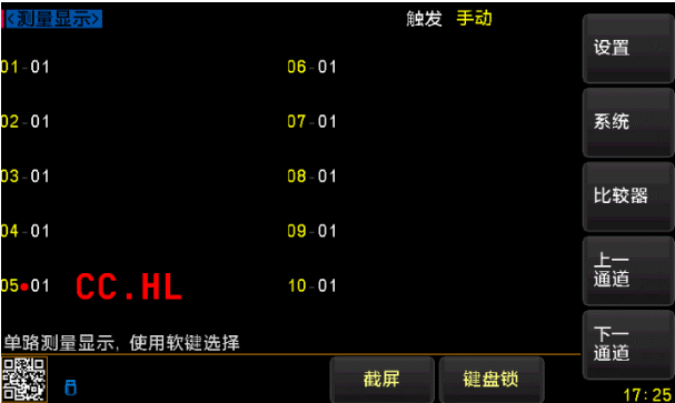
图 5-2 测试线全部接触不良
